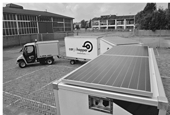
zonnepanelen op dak van laadbakken
